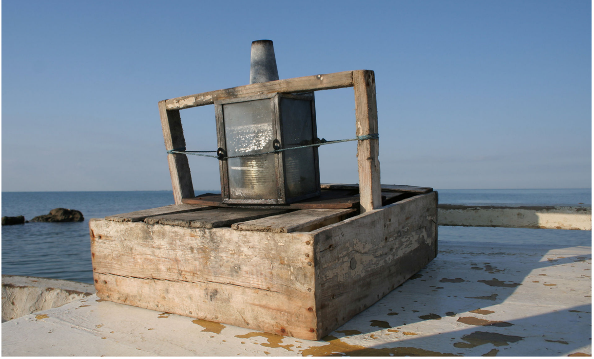
Şekil 4.3. Geceleri kullanılan işaret şamandırası (fennüs)
