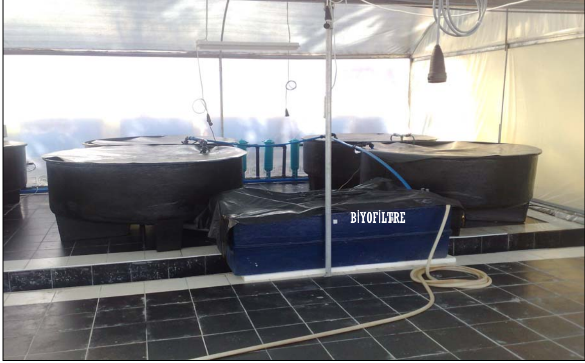
Şekil 2. Grup 1, 2, 3 ve 4'ün stoklandığı tank sistemi. Önde biyo-filtre ve arkada ise torba filtreler görülmektedir.
