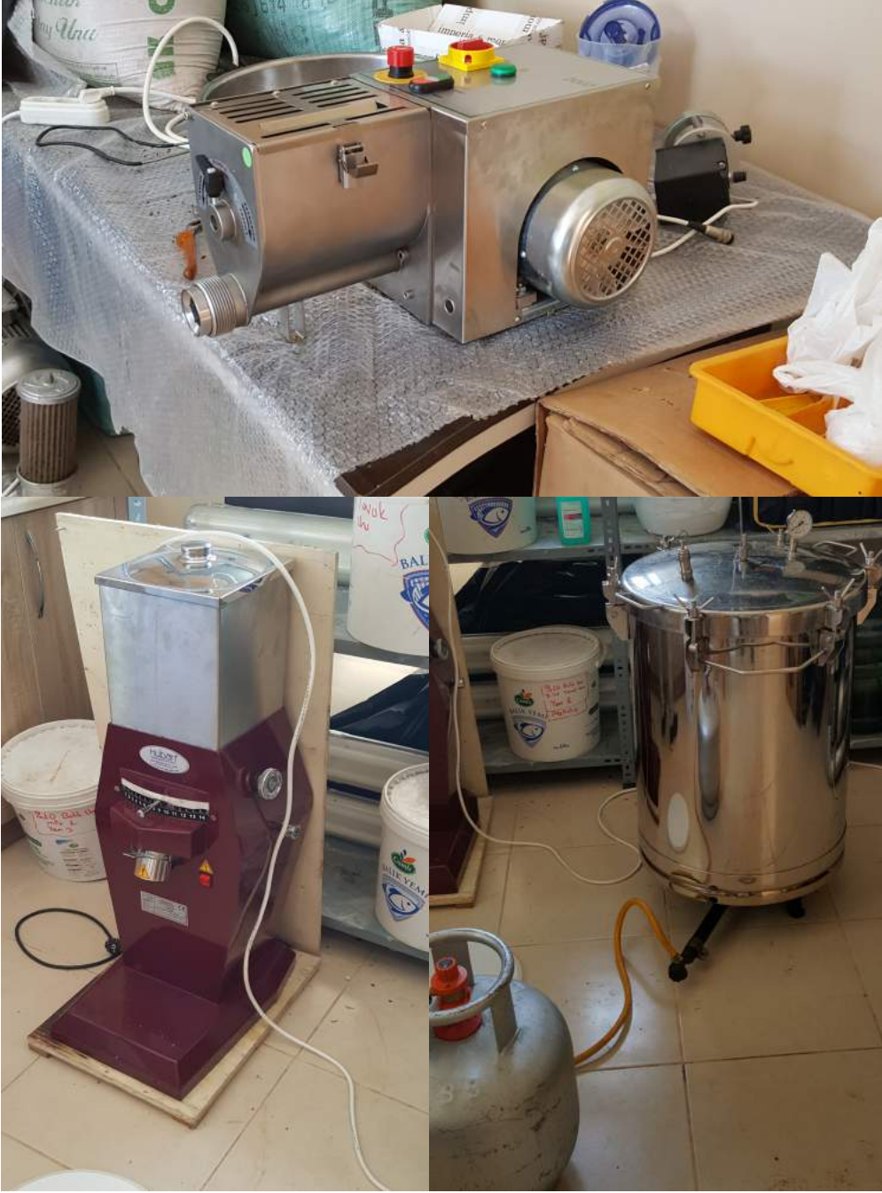
Şekil 3.4. Deneme yemlerinin preslendiği pelet makinası (üstte), hammaddelerin öğütüldüğü makina (solda) ve peletlerin pişirildiği düzenek (sağda).
